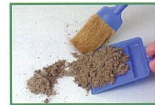
油を吸着した「オイルスポンジ」は、油を封じ込め、湿った土のようになりますので、取り扱いも簡単。油を吸着した「オイルスポンジ」は、ホウキやチリトリで手軽に回収できます。
